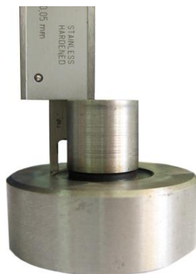
Rys.16. Poprawny pomiar głębokościomierzem suwmiarkowym. Właściwe położenie wybrania głębokościomierza
