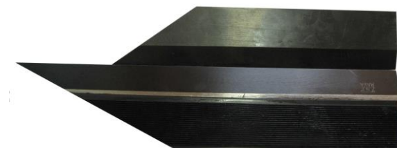
Rys. 73. Sprawdzanie liniału drugim liniałem
