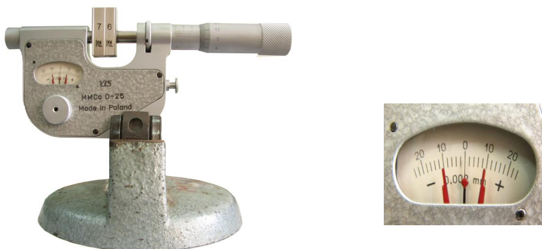
Rys. 84. Sprawdzanie transmetru płytkami wzorcowymi 7+6 = 13,000 [mm].
