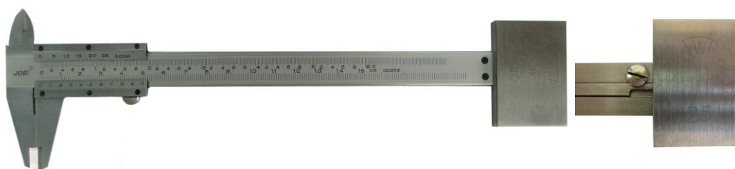
Rys. 3 Sprawdzenie wskazań zerowych głębokościomierza suwmiarki
