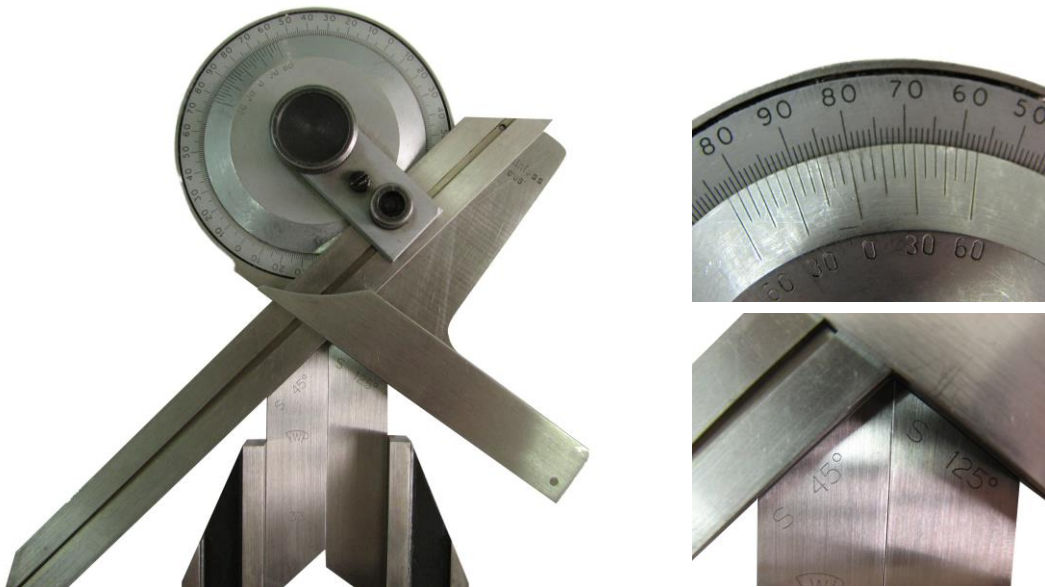
Rys. 65. Odwzorowanie kąta płytkami (45° i 55°). Sprawdzenie kątomierza. Wskaz 100°. Na kątomierzu jest wskaz 80° tzn. 90^\circ + (90^\circ - 80^\circ) = 100^\circ
