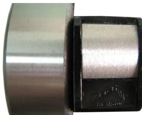
Rys. 71. Pomiar chropowatości powierzchni szlifowanych
