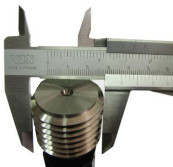
Rys. 27. Pomiar średnicy zewnętrznej gwintu
