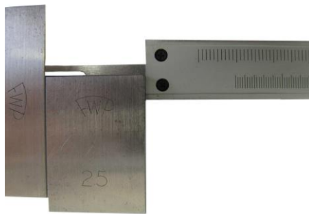
Rys. 6. Sprawdzanie poprawności wskazań głębokościomierza suwmiarki za pomocą płytek wzorcowych
