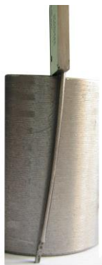
Rys. 15. Nadmierny nacisk na głębokościomierz
