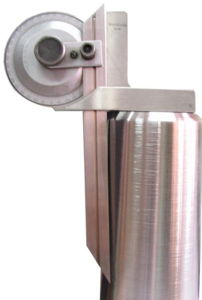
Rys. 51. Zukosowanie liniału kątomierza na stożku
