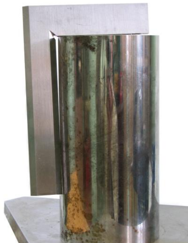
Rys. 62. Zukosowanie kątownika na walcu – pomiar błędny
