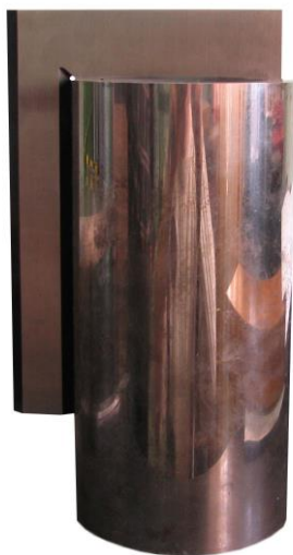
Rys. 55. Sprawdzenie kąta wewnętrznego kątownika krawędziowego
