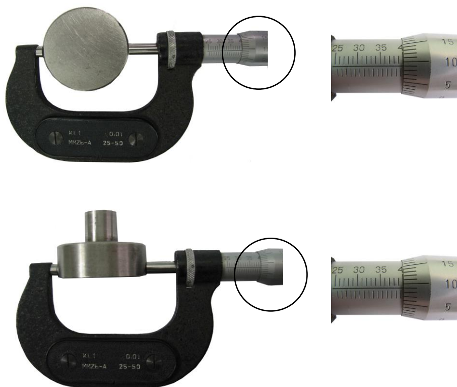
Rys. 24. Właściwe ustawienie mikrometru względem mierzonego wałka. Wymiar \phi 40,09 ( \phi 40^{+0,09} )
