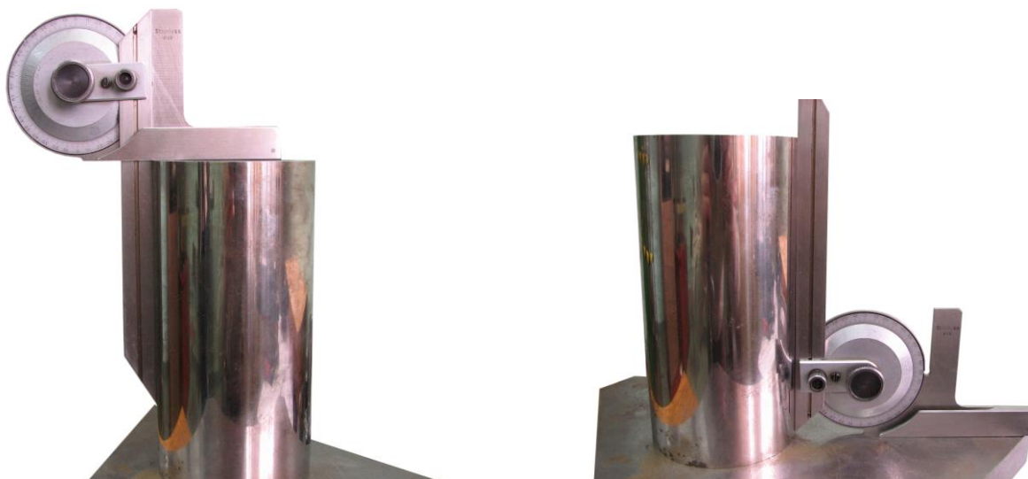
Rys. 49. Sprawdzanie kąta 90^\circ na kątowniku walcowym i płycie pomiarowej
