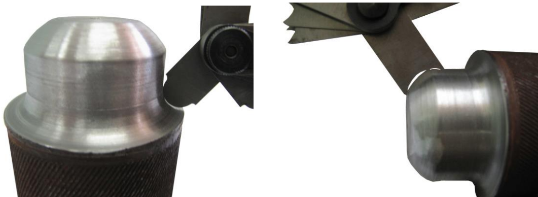
Rys. 31. Zbyt mały promień wzornika łuku
