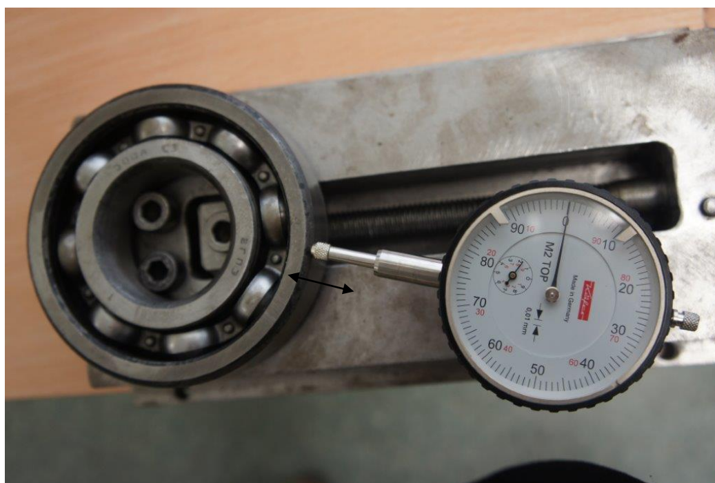
Rys. 82. Pomiar luzu łożyska kulkowego czujnikiem zegarowym z magnesem.
