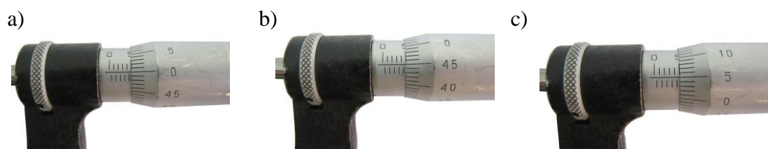
Rys. 23. Prawidłowe wskazzy na bębnie mikrometra:
