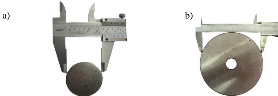
Rys. 11. a), b) Pomiar cięciwy walca. Błąd pomiaru
