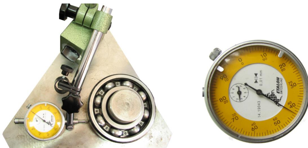
Rys. 81. Graniczne dopuszczalne odchylenia osi czujnika od osi łożyska ( 15^\circ )
