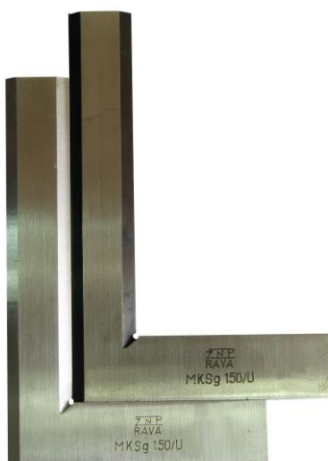
Rys. 57. Sprawdzanie kątowników przez porównanie wzajemne
