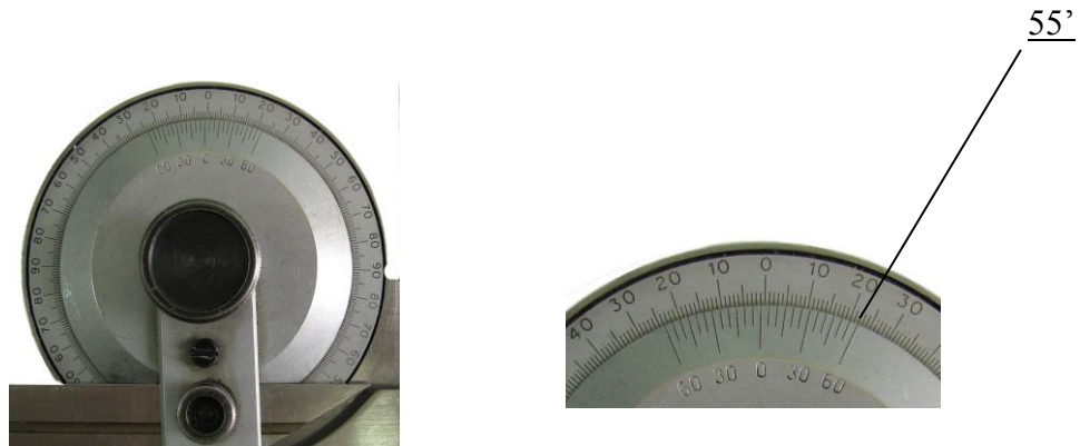
Rys. 52. Tarcza kątomierza. Wskaz 55' (minut kątowych)
