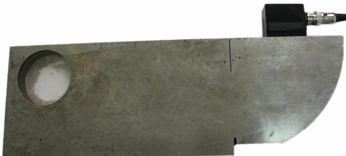
Rys. 95. Wzorzec kontrolny W1. Sprawdzenie głowicy skośnej
