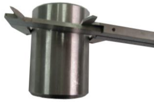
Rys. 10. Błąd zukosowania poprzecznego
