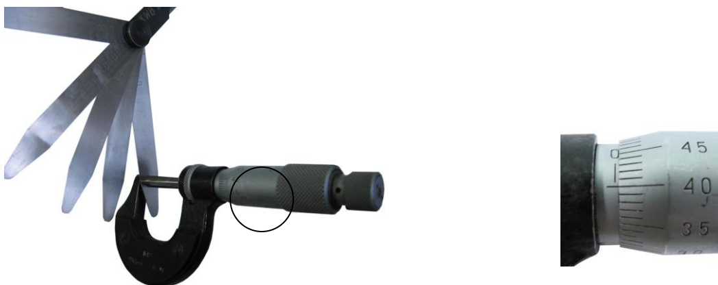
Rys. 77. Pomiar płytek szczelinomierza. Wymiar 0,40 mm
