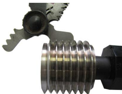
Rys. 25. Sprawdzanie płytki wzornika gwintu na sprawdzianu do gwintu. Pełne doleganie krawędzi
