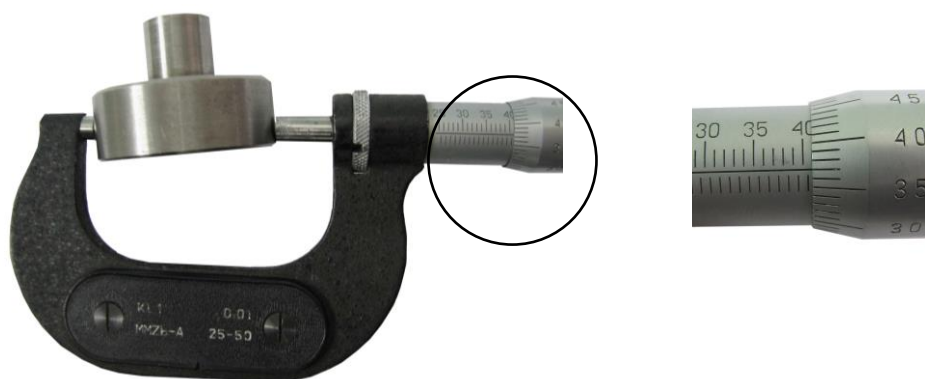
Rys. 21. Zukosowanie mikrometru na wałku. Wymiar \phi 40,87 \text{ mm} ( \phi 40^{+0,87} )
