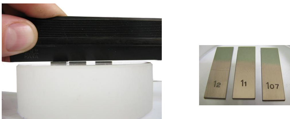
Rys. 76. Szczelina wzorcowa. Wymiary płytek: 1,2, 1,1, 1,07 [mm], tzn. szczelina 0,1 i 0,13 [mm]
