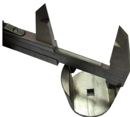
Rys. 17. Pomiar szerokości rowka – zukosowanie wzdłużne
