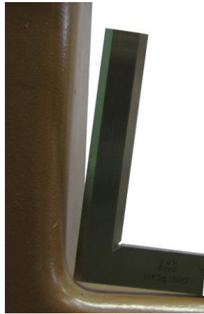
Rys. 61. Pomiar kąta wewnętrznego z promieniem – błędny
