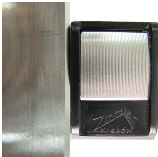
Rys. 69. Pomiar chropowatości otworu – wytaczanie
