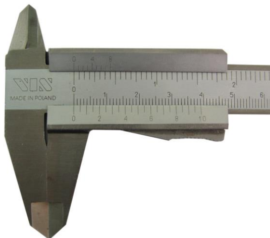
Rys. 2. Suwmiarka prawidłowa o dokładności wskazań 0,05 mm, moduł = 2
