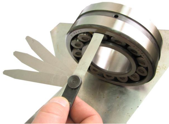
Rys. 78. Pomiar luzu łożyska opartego na pierścieniu zewnętrznym. Baryłkowe dwurzędowe
