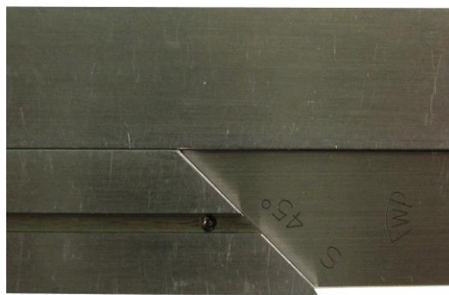
Rys. 48. Pomiar kąta 45° zakończenia liniału, wykonany płytką wzorcową i liniałem powierzchniowym
