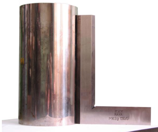
Rys. 63. Prawidłowy pomiar kąta prostego kątownikiem
