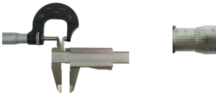
Rys. 8. Sprawdzenie poprawności wskazań szczęk krawędziowych mikrometrem, wymiar 10,00 mm
