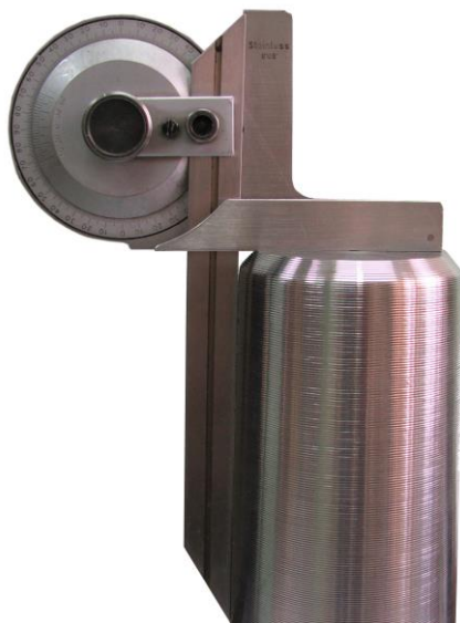
Rys. 54. Prawidłowy pomiar kąta stożka
