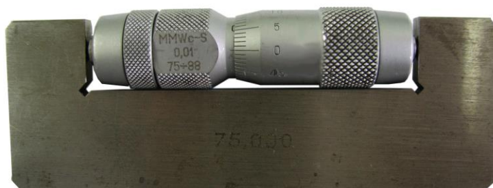
Rys.36. Sprawdzanie poprawności wskazań średnicówki. Wymiar 75,00 mm
