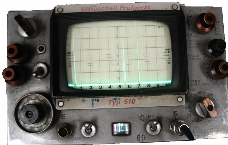
Rys. 91. Defektoskop ultradźwiękowy. Tablica sterownicza z ekranem oscyloskopowym. Obraz prześwietlania przedmiotu z rys. 90
