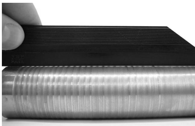
Rys. 11. Ocena falistości liniałem, z możliwością pomiaru szczeliniomierzem
