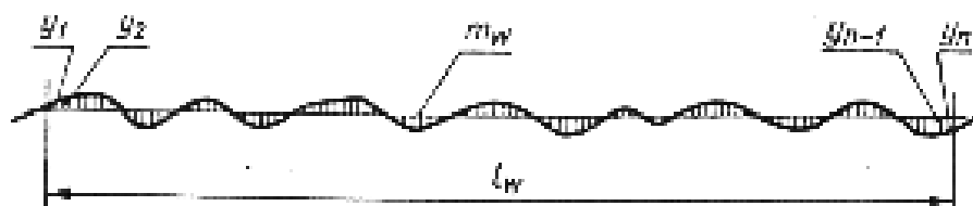
Rys. 9. Linia średnia profilu falistości m_w
