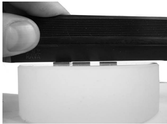
Rys. 12. Pomiar falistości za pomocą szczeliny wzorcowej
