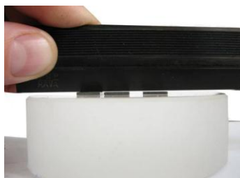
Rys. 10 Tworzenie szczeliny wzorcowej na płytkach wzorcowych. Szczeliny 0,13 mm i 0,1 mm
