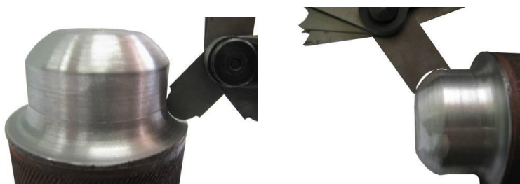
Rys. 3. Zbyt mały promień wzornika łuku
