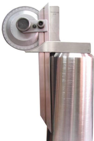
Rys. 47. Zukosowanie liniału kątomierza na stożku
