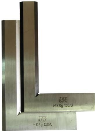
Rys. 51. Sprawdzanie kątowników krawędziowych przez porównanie wzajemne
