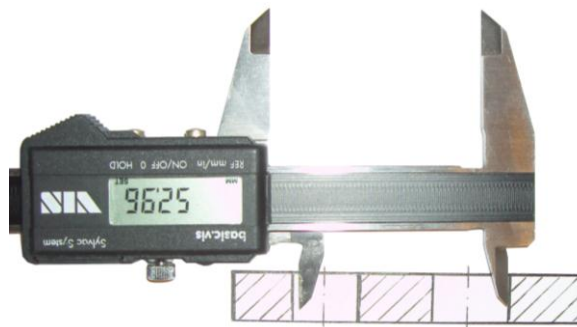
Rys.17. Pomiar rozstawu dwóch otworów przy pomocy suwmiarki uniwersalnej:
