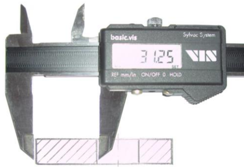
Rys.18. Pomiar odległości otworu od krawędzi płytki
