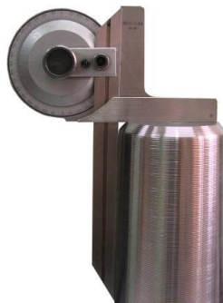
Rys. 46. Prawidłowy pomiar kątomierzem kąta stożka
