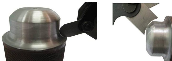
Rys. 2. Nadmierny promień wzornika łuku
