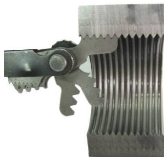
Rys. 26. Pomiar podziałki gwintu wewnętrznego
