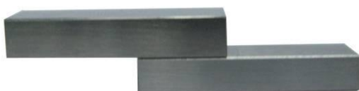
Rys. 52. Składanie płytek wzorcowych przez nasuwanie
