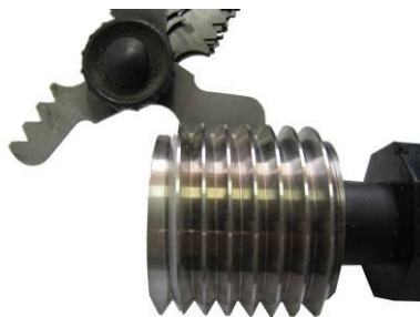
Rys. 4. Sprawdzanie gwintu sprawdzianem do gwintu. Pełne doleganie krawędzi
