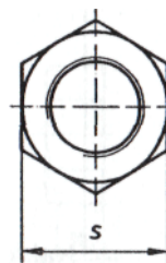
Rys. 24. Szerokość nakrętki s (wymiar pod klucz)
