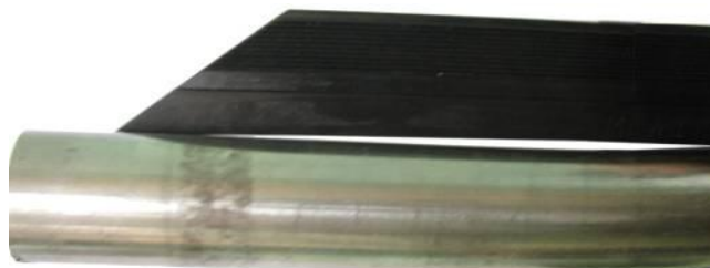
Rys. 8. Sprawdzanie odchyłek od walcowości za pomocą liniału krawędziowego. Wygięcie wałka
