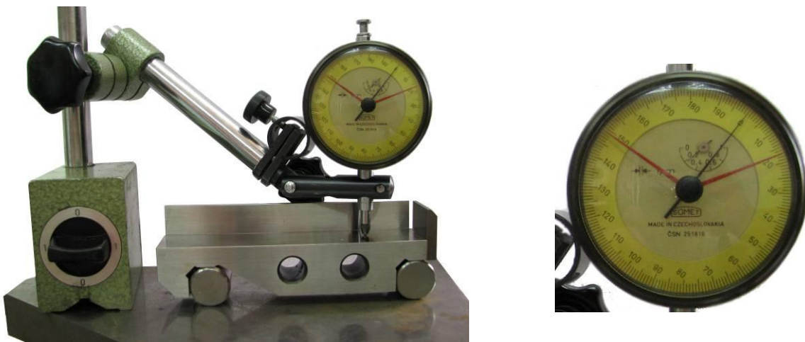
Rys. 49 Sprawdzanie liniału sinusowego. Wskaz zero
