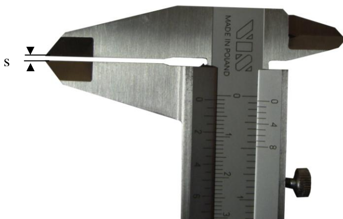
Rys. 9 Tworzenie szczeliny wzorcowej na suwmiarce. Wymiar szczeliny 1 mm
