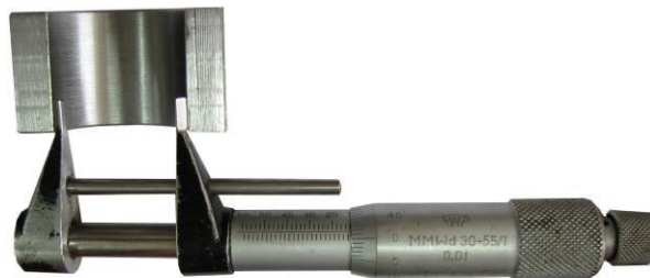
Rys. 19. Pomiar otworu mikrometrem wewnętrznym
