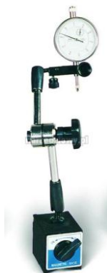
Rys. 35. Czujnik zamocowany w uchwycie podstawki
