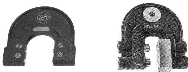
Rys. 26. Sprawdzian szczękowy nastawny z płytką wzorcową
