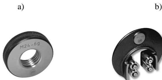
Rys. 30. Sprawdziany do gwintu zewnętrznego: a) pierścieniowy MSRk , b) szczękowy rolkowy MSNa
