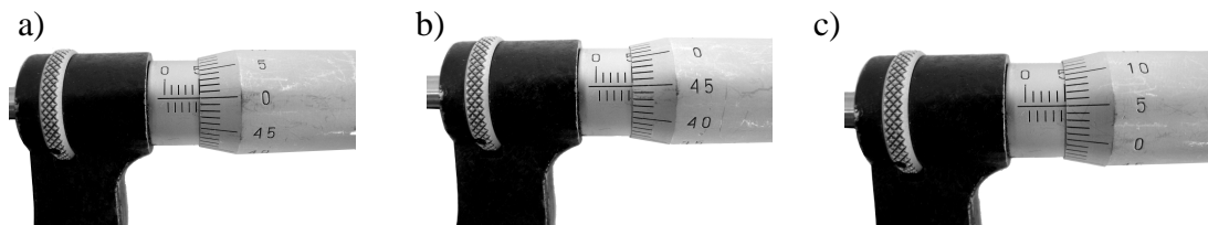
Rys. 10. Prawidłowe wskazzy na bębnie mikrometra: a) wymiar 5,00 mm, b) wymiar 4,95 mm( 5^{-0,05} ) c) wymiar 5,05 mm( 5^{+0,05} )
