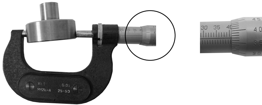
Rys. 8. Zukosowanie mikrometru na wałku. Wymiar \phi 40,87 \text{ mm} ( \phi 40^{+0,87} )
