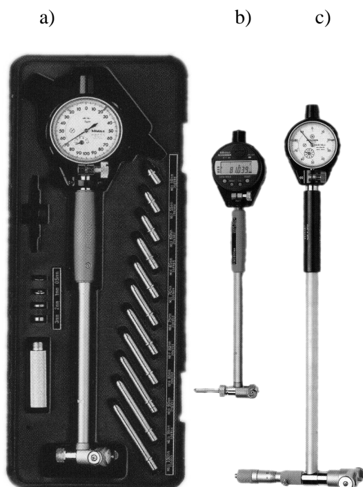
Rys. 9. Średnicówka czujnikowa dwustykowa: 1) zestaw kompletny w pudełku, 2) średnicówka z czujnikiem elektronicznym w wersji roboczej, 3) średnicówka z czujnikiem zegarowym w wersji roboczej.
