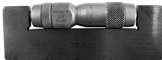
Rys. 3. Sprawdzanie poprawności wskazań średnicówki składanej. Wymiar 75,00 mm
