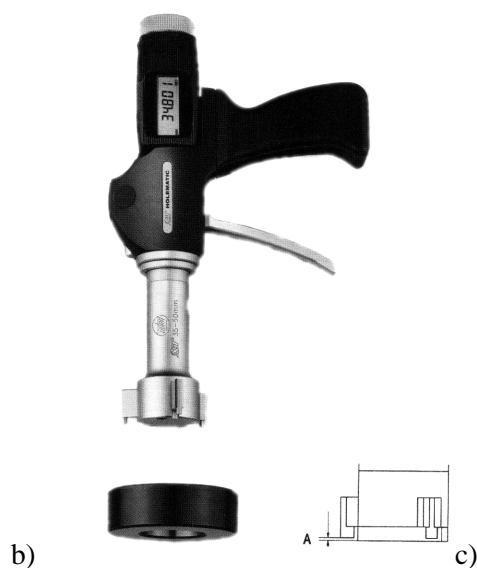
Rys. 13. Średnicówka czujnikowa trójpunktowa: a) urządzenie pomiarowe, b) pierścień wzorcujący, c) pomiar otworu nieprzelotowego
