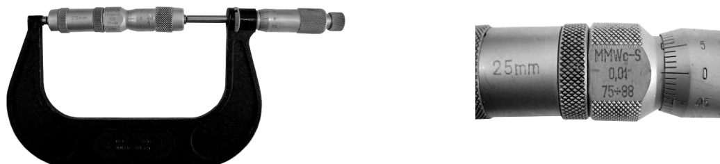
Rys. 4. Sprawdzanie średnicówki z przedłużaczem 25 mm, wymiar łączny 100,00 mm
