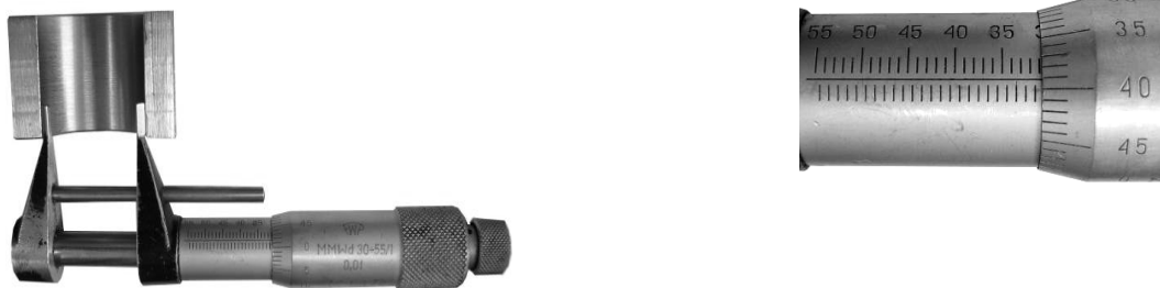
Rys. 17. Prawidłowy pomiar otworu mikrometrem wewnętrznym. Wymiar 30,89 mm ( 30^{+0,89} )
