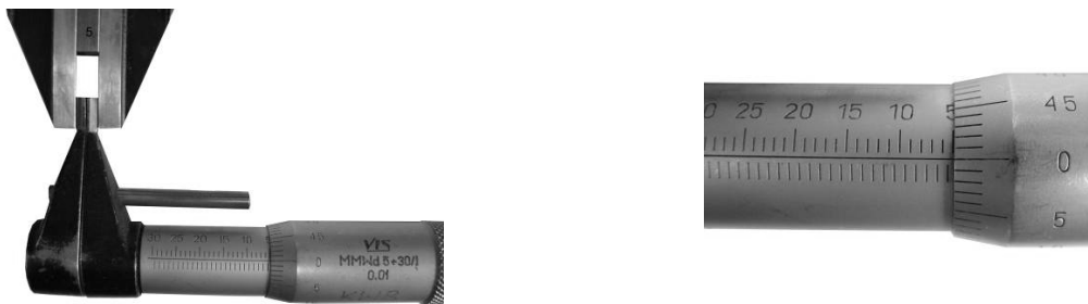
Rys. 16. Sprawdzanie wskazania 5 mm mikrometra wewnętrznego na płytkach wzorcowych w uchwycie
