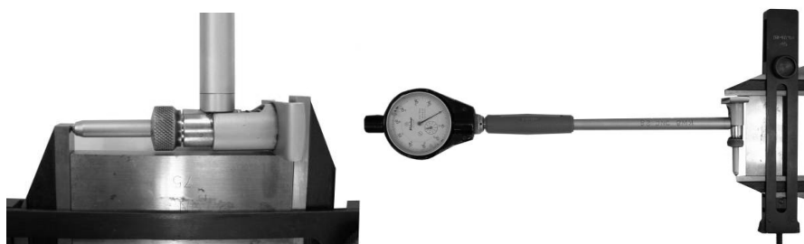
Rys. 10. Skalowanie średnicówki dwustykowej na płytce wzorcowej w uchwycie
