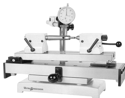
Rys. 43. Przyrząd kłowy – pomiar zbieżności stożka
