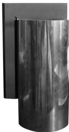
Rys. 2. Sprawdzanie kąta wewnętrznego kątownika krawędziowego.
