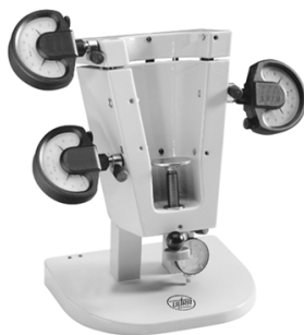
Rys. 44. Przyrząd specjalny do pomiaru stożka
